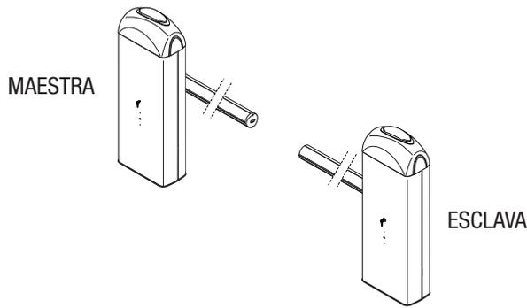
En la tarjeta electrónica de la barrera MAESTRA, efectuar las conexiones eléctricas, la activación del mando radio, la programación de las funciones y las regulaciones.
