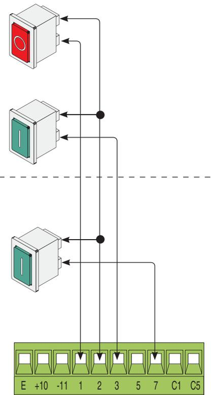
Función SOLO ABRE o ABRE-CIERRA-INVERSIÓN (paso-paso) desde dispositivo de mando (contacto NA), véase DIP 2.
