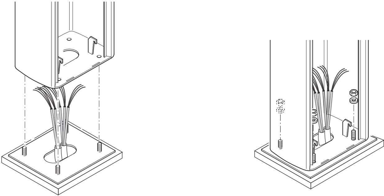
Acoplar el cubre-enganche del mástil, la placa intermedia y la placa del árbol motor con un tornillo. Dejar el tornillo flojo para facilitar la posterior introducción del mástil.
