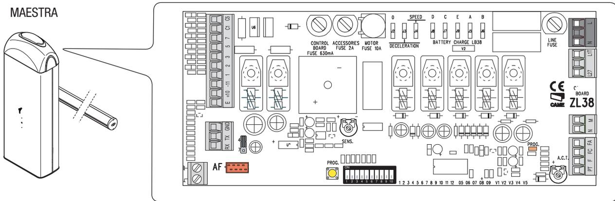
En la tarjeta electrónica de la barrera ESCLAVA, conectar la alimentación en L-N, el intermitente en 10-E, poner en ON el DIP 7 y ajustar la velocidad de movimiento y de las ralentizaciones como en la tarjeta electrónica de la barrera MAESTRA.
