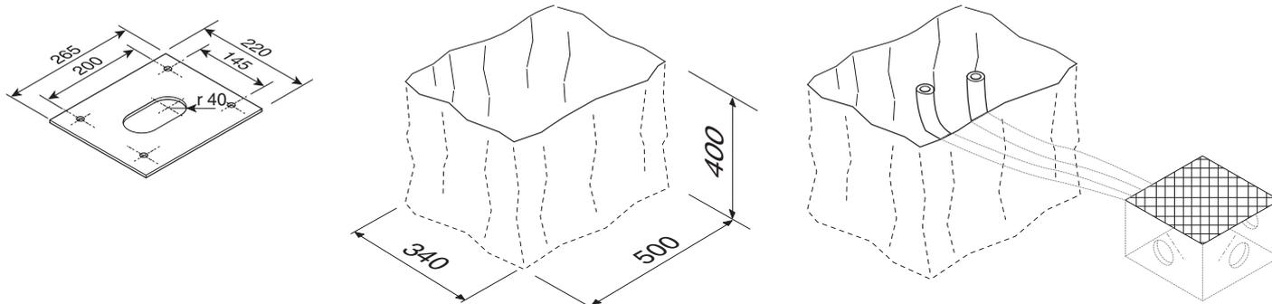
Preparar un encofrado de dimensiones mayores que la placa de anclaje e introducirlo en el hoyo.
