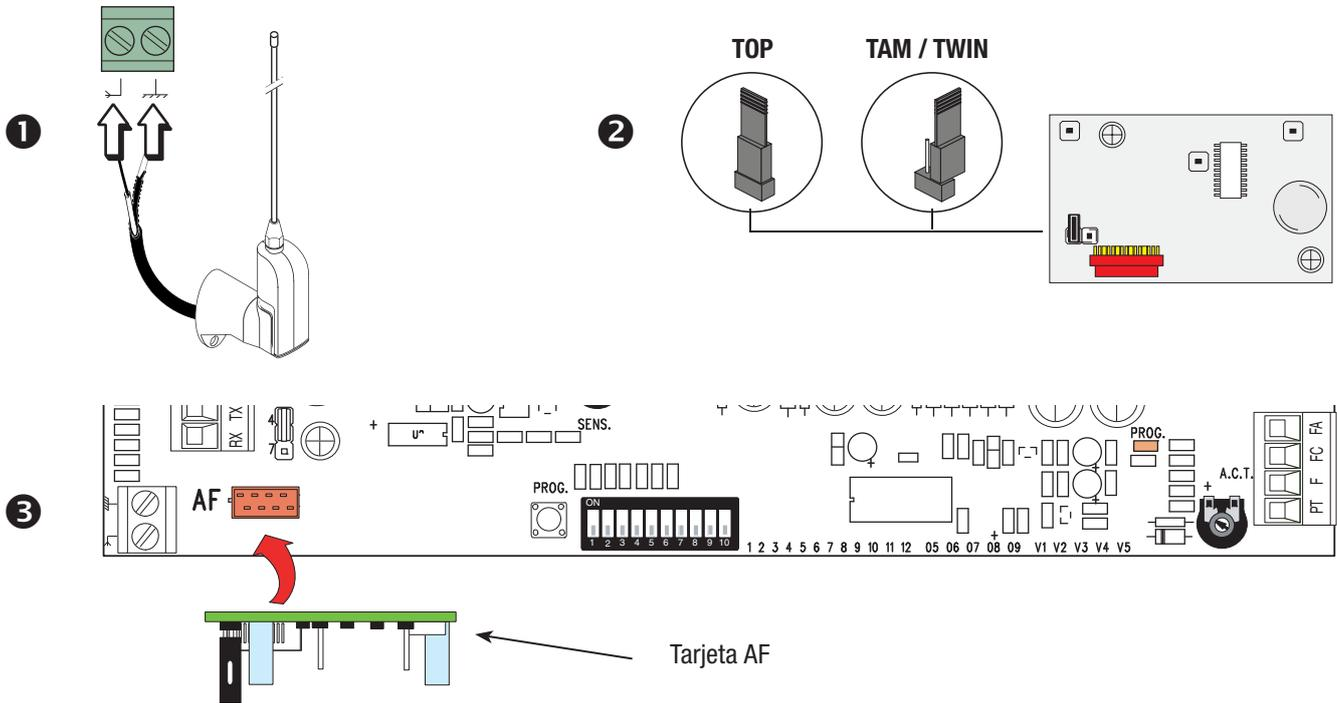
Mantener presionado el pulsador de programación PROG en la tarjeta electrónica. El LED de programación parpadea **4**.
